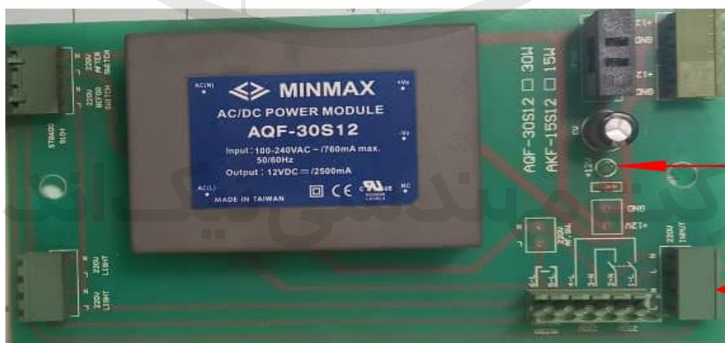
تصویر ۷-۱ کارت تغذیه (power)
